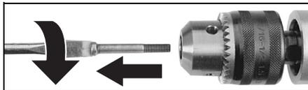
Retirar o parafuso de fixação. Atenção rosca à esquerda!
