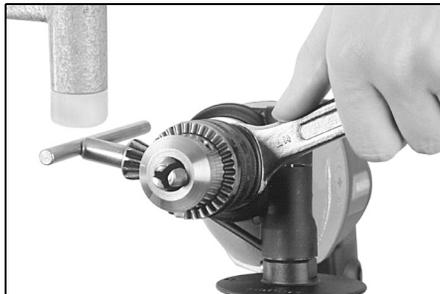
Segurar o veio com uma chave de forqueta. Soltar e desaparafusar a bucha, mediante uma batida leve com um martelo de borracha sobre a chave da bucha inserida.
