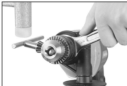
Maintenir la broche de perçage avec une clé à fourche. Frapper légèrement sur la clé de mandrin enfoncée avec un marteau en caoutchouc pour desserrer le mandrin de perçage et le dévisser.
